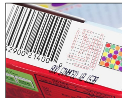
Onleesbare en verkeerd geplaatste code
